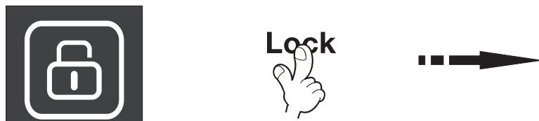
■ При работе холодильника в данном режиме остальные кнопки панели управления функционировать не будут; при прикосновении к ним будет раздаваться звук «колокольчика» и на экране будет мигать значок блокировки.
